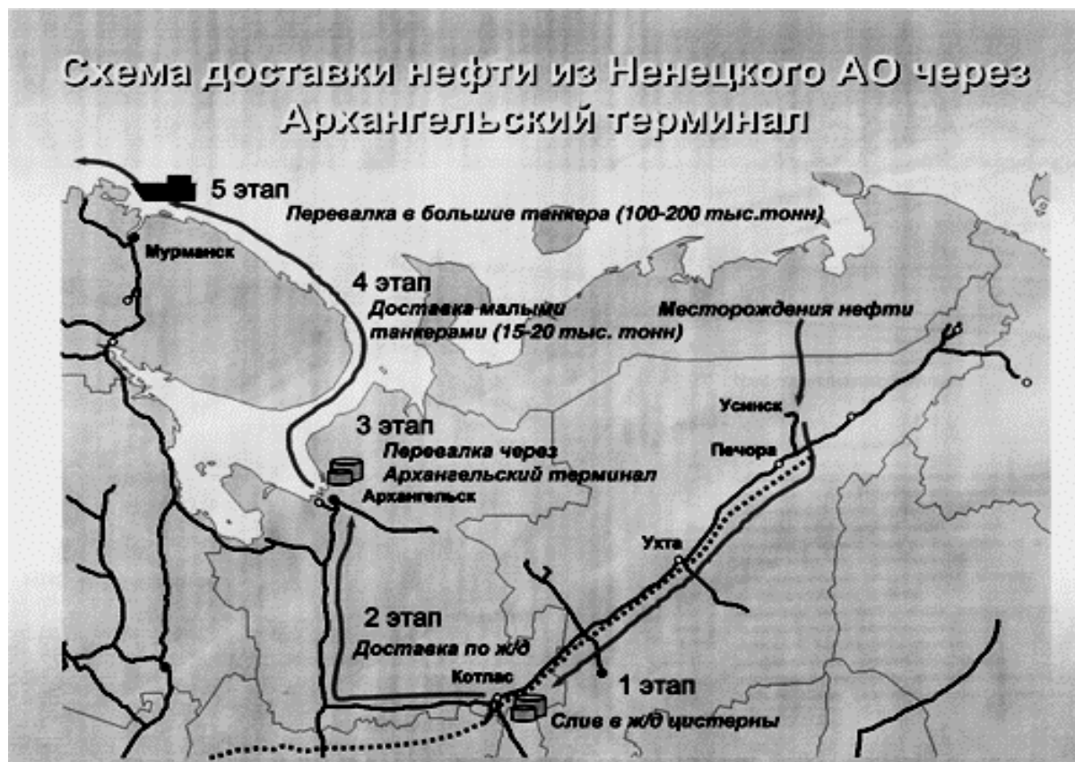
Рис. 1. Схема доставки нефти из Ненецкого автономного округа через Архангельский терминал
